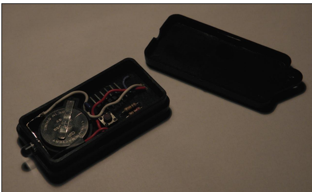
obr. 12 Otevřený dálkový ovladač
