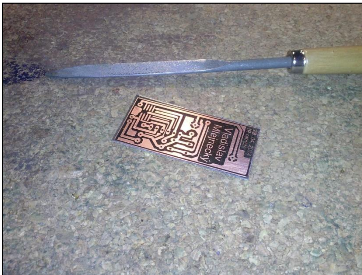
obr. 9 Vyleptaný plošný spoj
